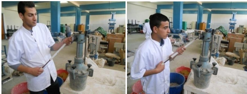
Figure III. 4: Aéromètre à béton
