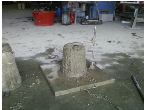
Figure III. 3: Mesure de l'affaissement du béton au cône d'Abrams (Affaissement égal à 4,8 cm)
