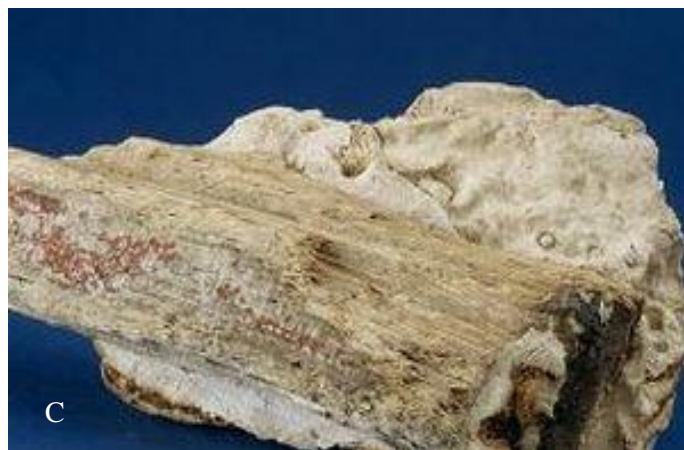
Figure 1 : Différents types de pourriture du bois : A : Pourriture cubique (champignon indéterminé), B : Pourriture fibreuse ( Trametes versicolor ), C : Pourriture molle (champignon indéterminé)
