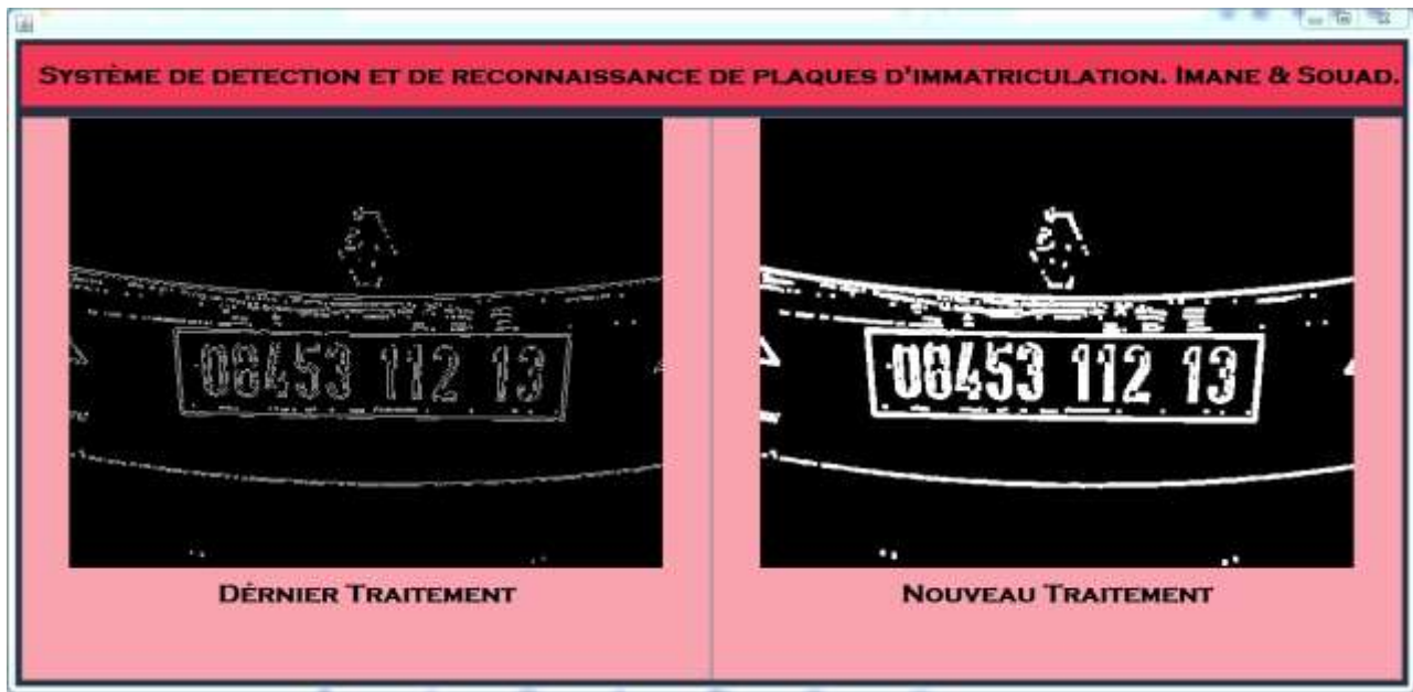
Figure 14 : fenêtre de dilatation.
