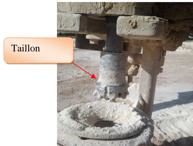
Figure 12: Trou réalisé par foreuse Figure 13: Taillon 89,tige 45
