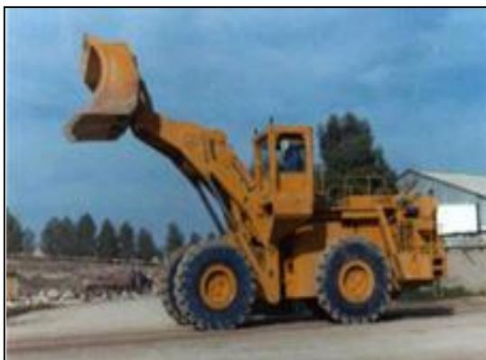
**Photo15** : Chargeuses sur pneus
