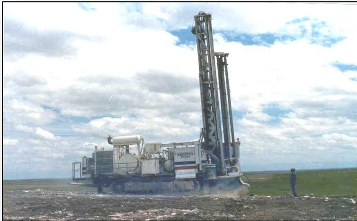
**Photo 3 : Sondeuse rotative reedrill SK 60 II - DIESEL**
