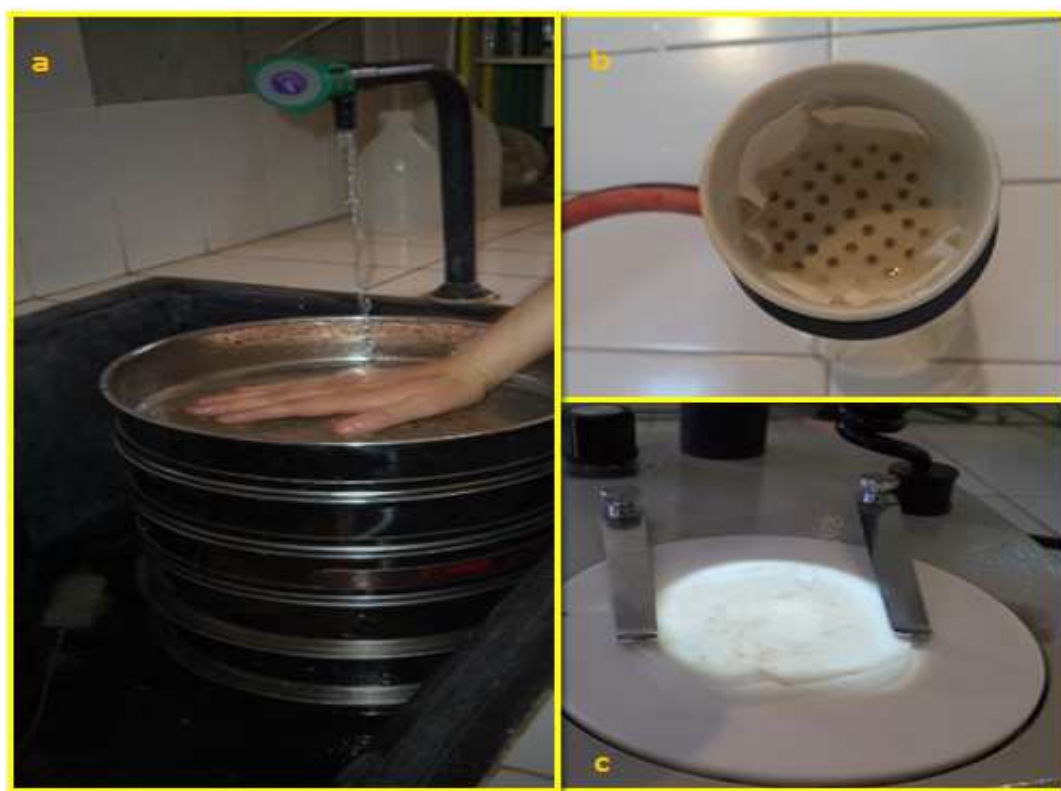
Figure 13 a : Op  ration de tamisage. b : Filtration de surnageant sous vide sur des filtres wathman.
