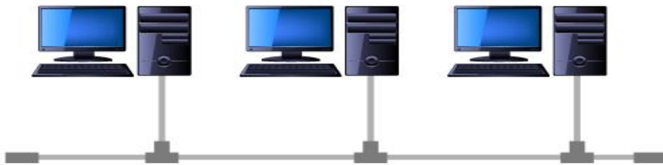
Fig. 2.10 Topologie en bus [46]
