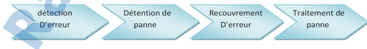
Figure II.4 : Procédure générale de tolérance aux pannes
