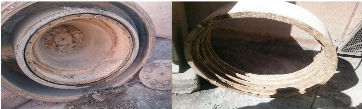
Figure IV-7 : Photos de Démontage du bol du concentrateur
