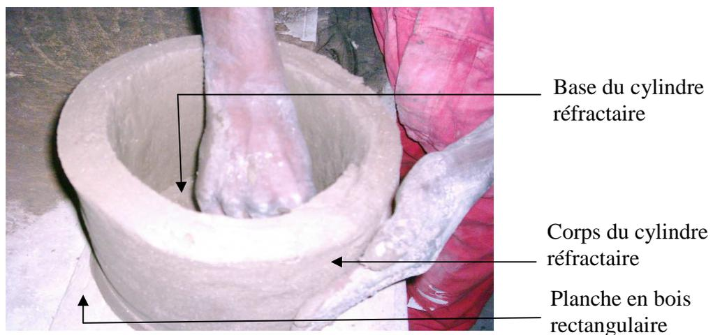
**Figure 18 : Confection et soudure de la base et du corps du cylindre réfractaire**
