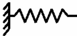
Figure.III. 10. Modèle linéaire, la déformation est proportionnelle à la contrainte.
