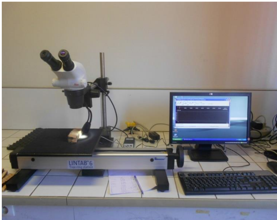
Figure 24 : La machine LinTab6 utilisée pour mesurer les épaisseurs des cernes du liège
