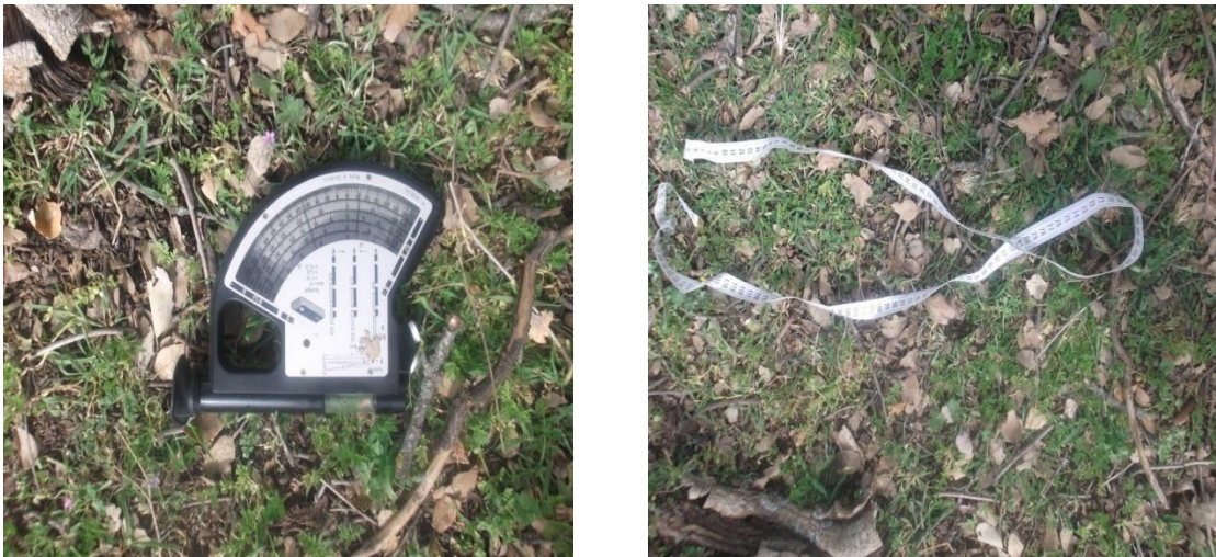
Figure20 : Matériel nécessaire utilisé pour les mesures dendrométriques : Blum Leiss (à gauche), mètre ruban (à droite).
