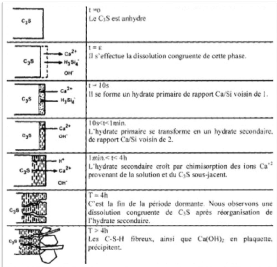
Figure 13 : Schéma d'un modèle de l'hydratation initiale du C_3S [9].
