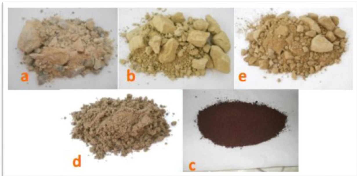
Figure 11 : matières premières constituant le ciment ; a)calcaire,b)argile, c)schiste, d)sable, e) minerais de fer
