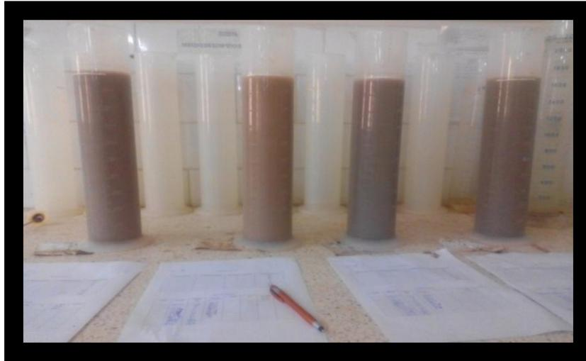
**Photo N° 3 : Sédimentation de nos échantillons au laboratoire.**
