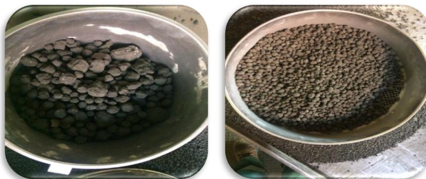
**Figure 8: Grains de clinker sortant du four**
