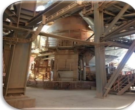
**Figure 5: Broyeur du cru**
