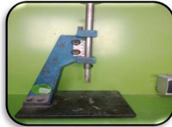
**Figure 17 : moule tronconique/ appareil de Vicat**
