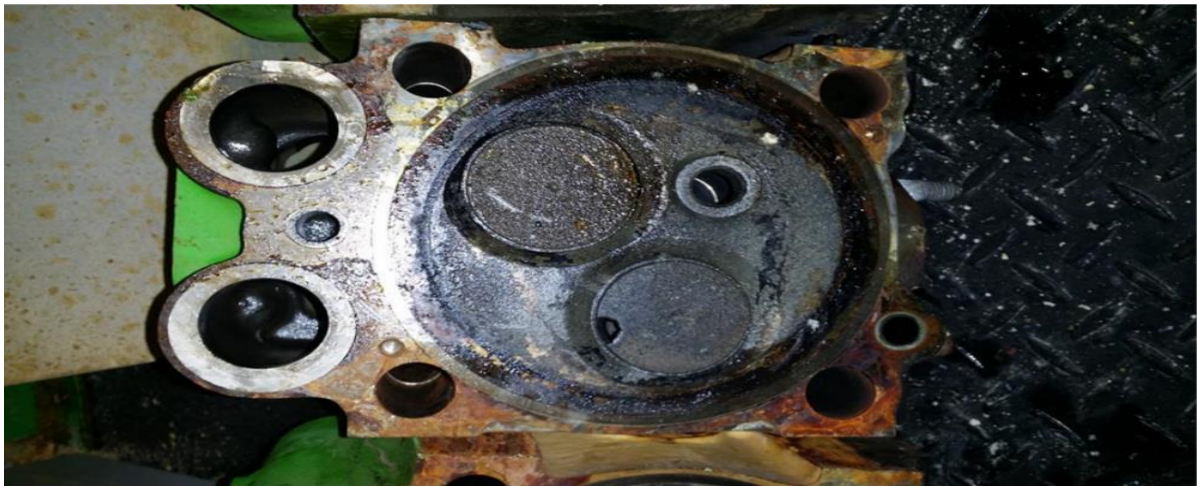
Figure 19: Dégâts causés par le sulfure d'hydrogène sur un moteur bioélectrique après 10000h de fonctionnement
