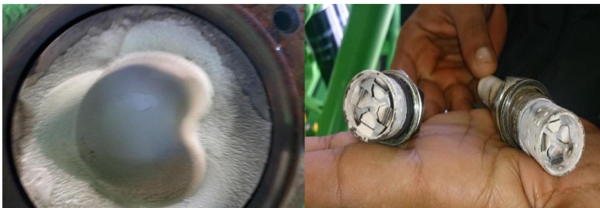
Figure 20 : Dégâts causés par les siloxanes sur les moteur et dépôts de silice sur les bougies d'allumage
