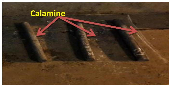
Figure 34 : Après Enfournement, Décalaminage et pesage des barres
