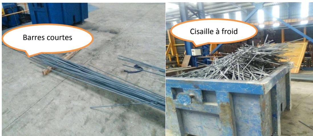
**Figure 41 : Les pertes cisaille à froid et barres courtes**
