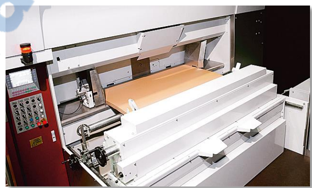
Figure 14: Taquage latéral à l'introducteur avec soufflerie
