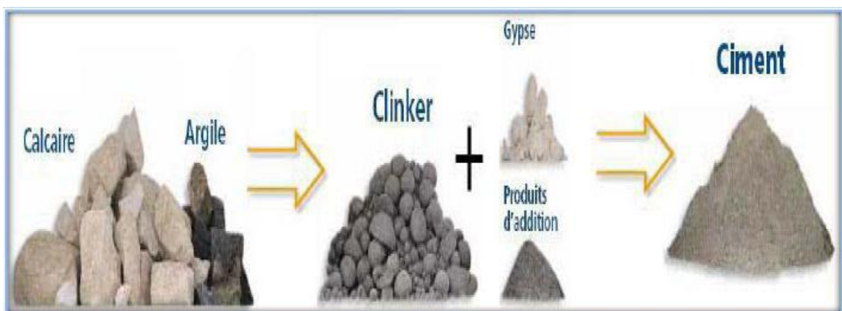
Figure 3: Les composants du ciment
