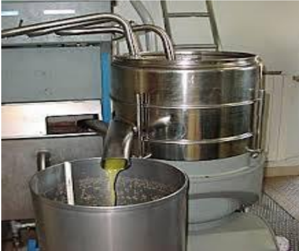
Figure I-8 : Sortie de l'huile par la centrifugeuse.
