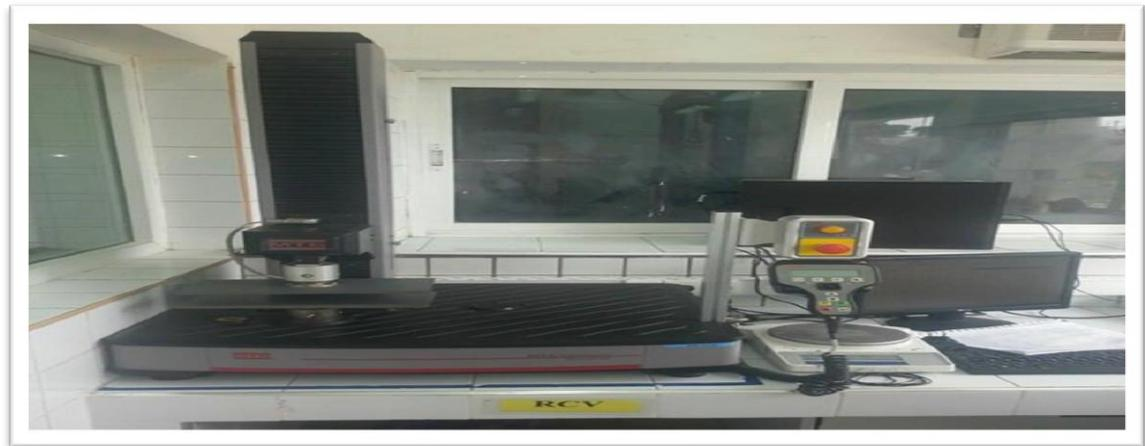
**Figure 9 : Appareil de mesure de la résistance des pots vides**
