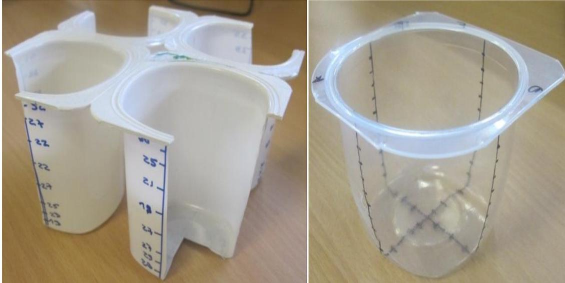
**Figure 12 : Mesure de l'épaisseur des pots vides**
