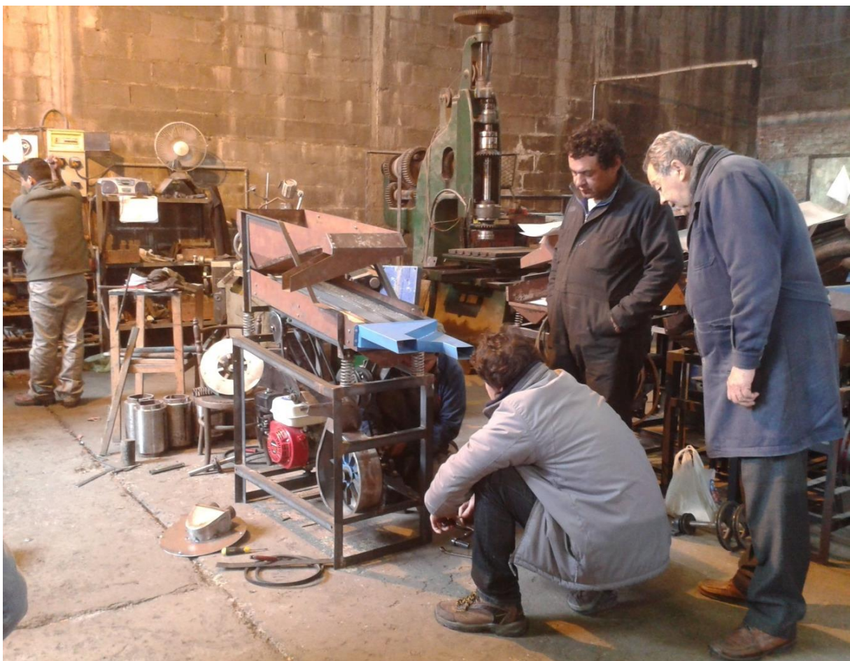
Photo 10 Conception d'un prototype de venteadora (trieuse) de Quinoa dans l'atelier métallurgique Flama, à Palpalá dans la province de Jujuy. Mai 2016
