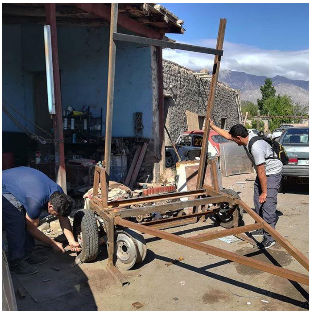
Photo 6 Le prototype du Banco semi-mecanico de cosecha encours de fabrication, atelier Retamo, périphérie de San Juan, décembre 2017
