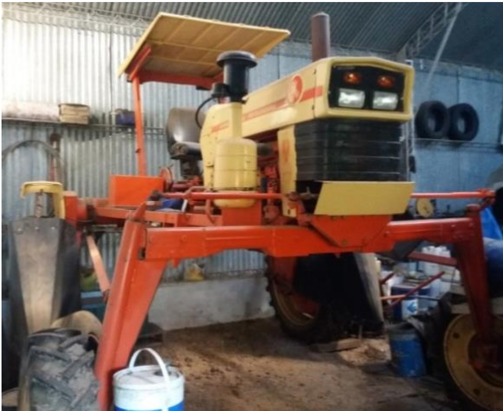
Photo 13 Le tracteur, conçu pour ne pas endommager les cultures de maïs au moment de semer le soja, est aujourd'hui entreposé dans le garage d'Alfonso J.
