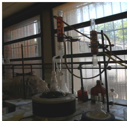
Figure 16: Hydrodistillation du thym (Cliché: Auteur, 2011)
