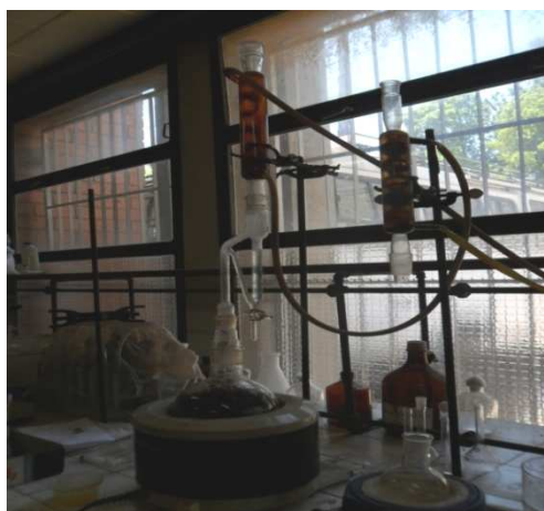
Figure 18: Hydrodistillation de l'huile essentielle de thym (Cliché: Auteur, 2010)
