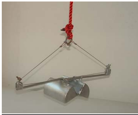
Photo N°1 : Préleveur de sédiment type Van Veen grab
