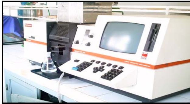
Photo N°3 : Spectrophotomètre absorption atomique flamme SOLAR (CNRE)
