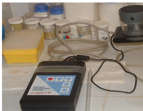
Photo N°5 : « trace element analyser » pour l'analyse de métaux lourds (CNRE)
