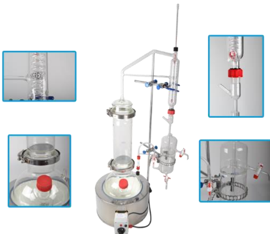
Figure 4 : Appareil de type Clevenger, répondant aux exigences et aux normes de la pharmacopée européenne (13)
