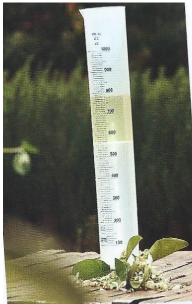
Figure 2 : Eprouvette montrant l'hydrolat (partie inférieure) et l'huile essentielle (partie supérieure) obtenus après distillation (6)
