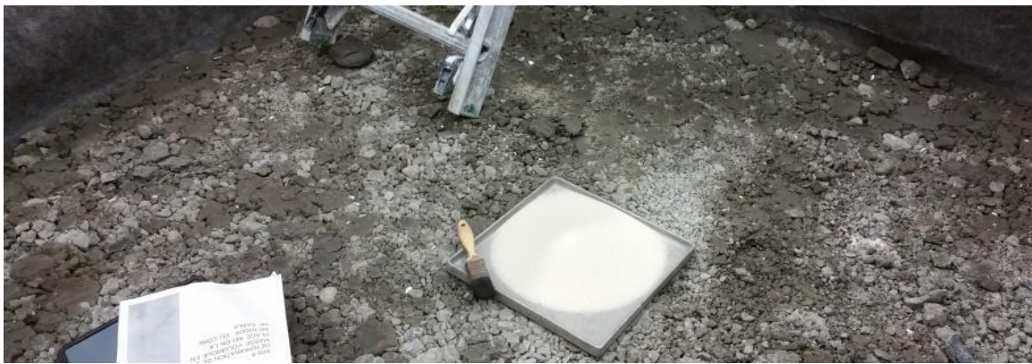
Figure 43 : Agglomérations de particules argileuses dans le sol d'infrastructure
