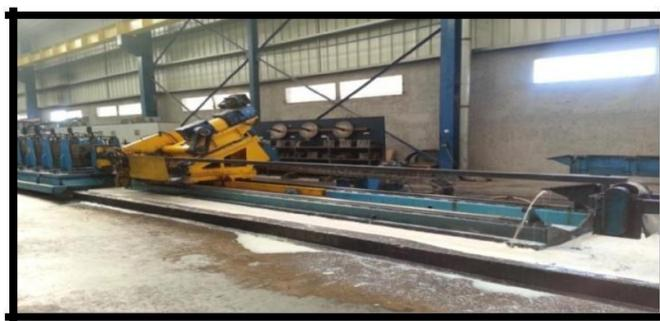
**Figure 13:** Dispositif de coupe longitudinale du tube
