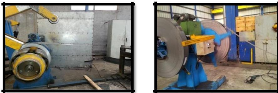
**Figure 6:** Feuillard déposé sur l'axe du dérouleur-machine tube 1
