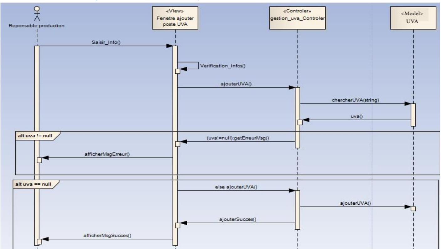
Figure 15 Diagramme de séquences d'un nouveau poste UVA
