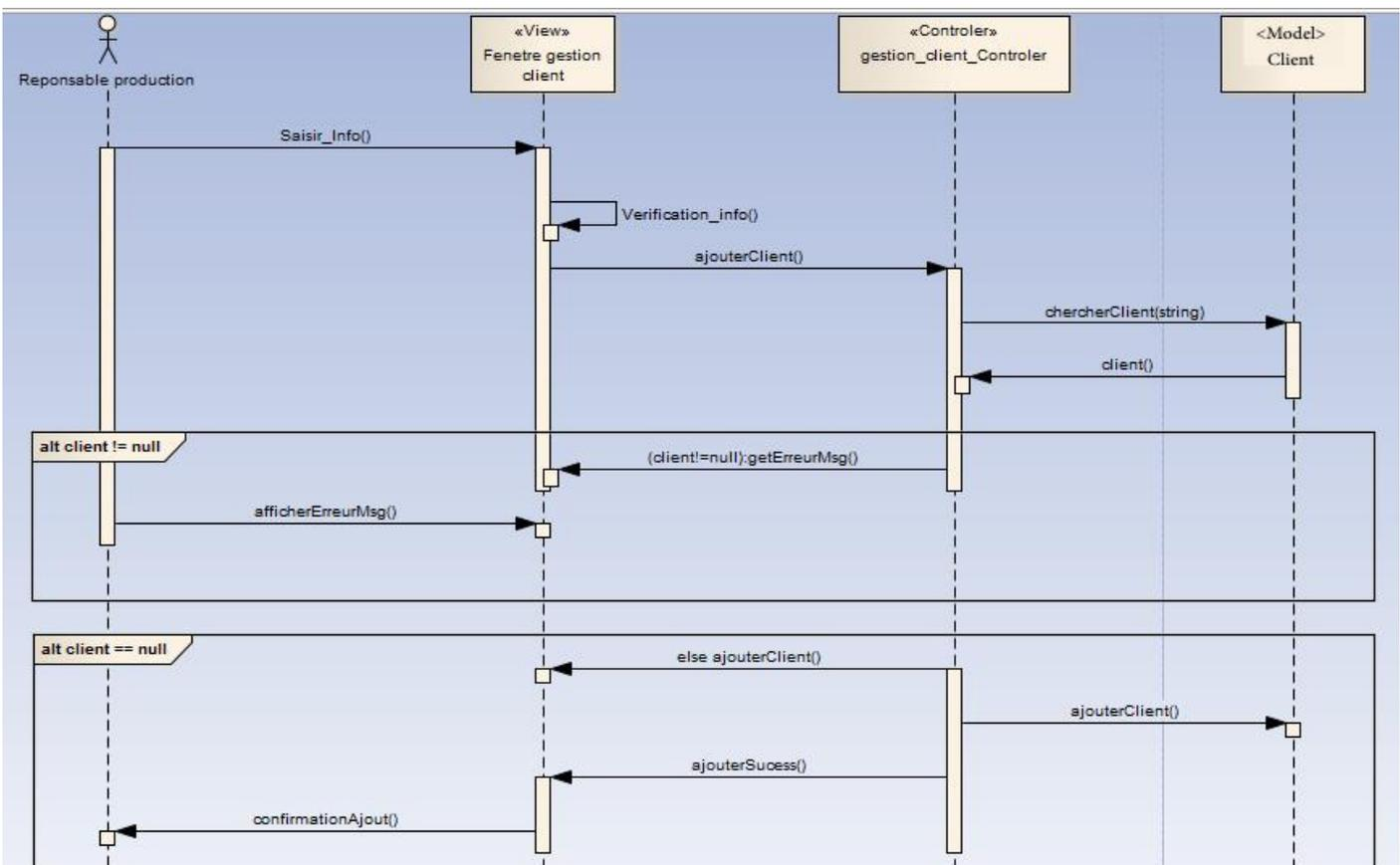
Figure 17 Diagramme de séquences d'ajout d'un nouveau client
