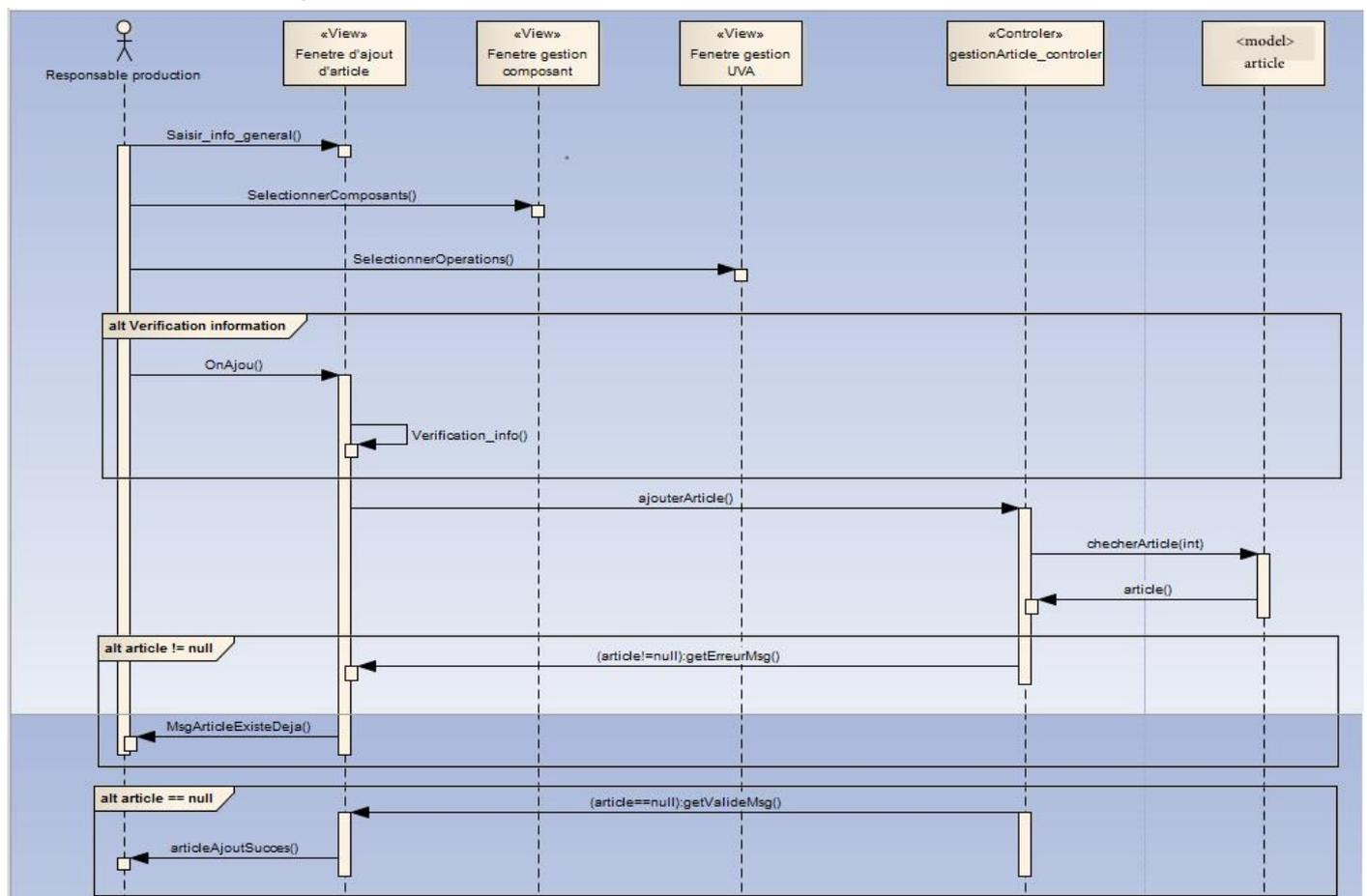
Figure 13 Diagramme de séquences d'ajout d'un nouvel article
