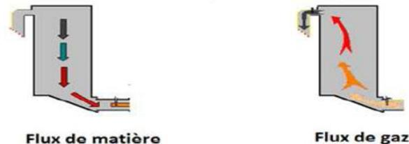
**Figure 4 : Différents flux dans la tour de préchauffage**
