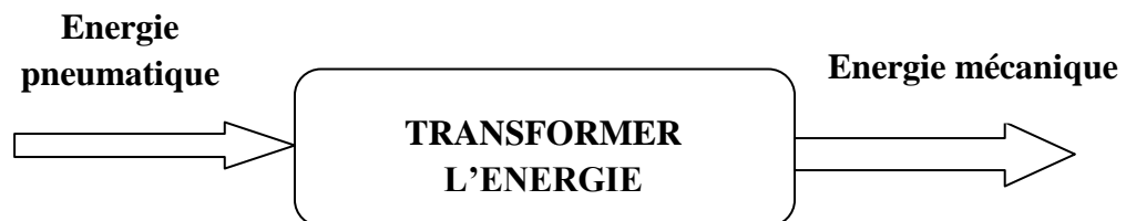
Figure 12 : rôle du vérin
