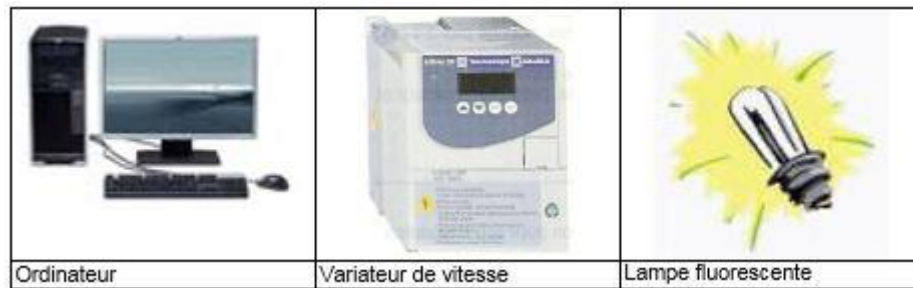
FIGURE 3.3 : EXEMPLES DE CHARGES NON LINEAIRES CAUSANT DES HARMONIQUES
