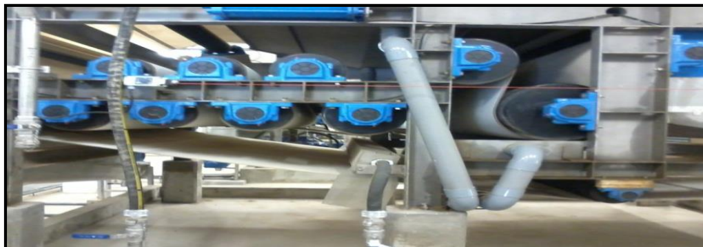
FIGURE 1.8 : FILTRE A BANDE STEP FES
