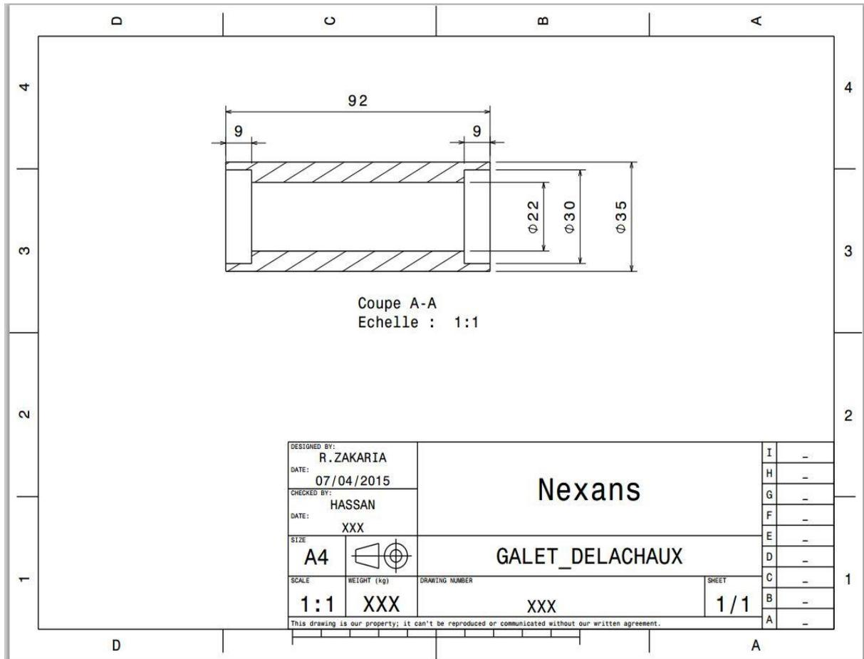
*ANNEXE 10 : Plan d'une poulie de la machine B11*
