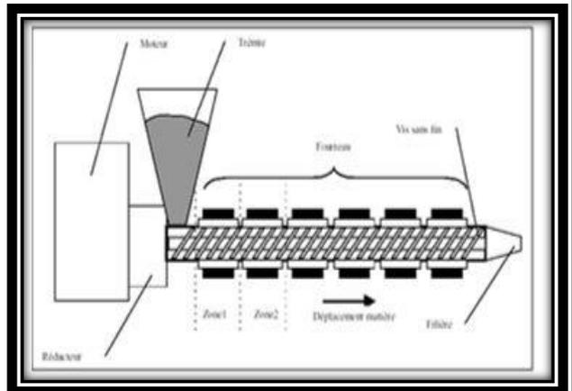
Figure 6 : Une extrudeuse
