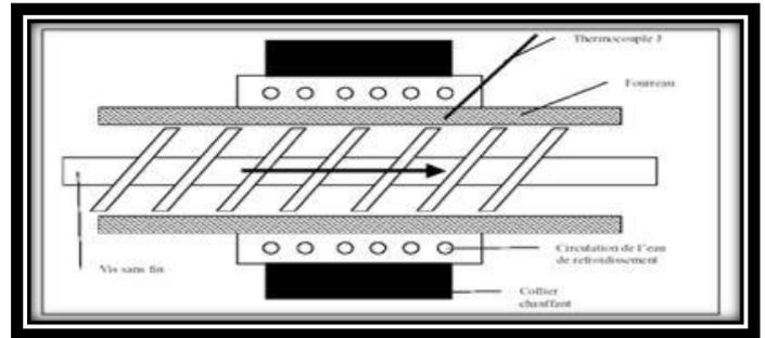
Figure 10 : Détail du contenu du vis
