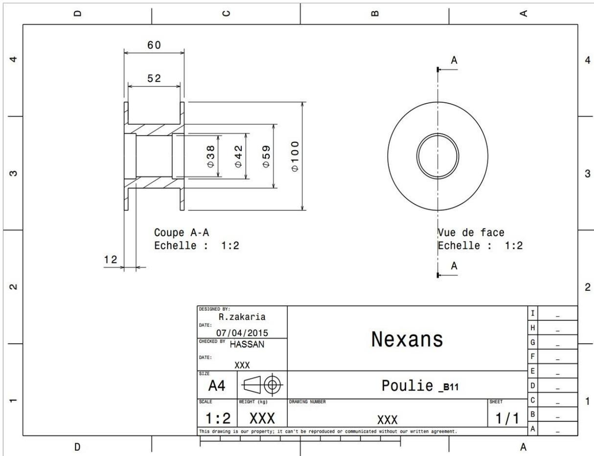
**ANNEXE 11 : Plan d'une poulie de renvoi de la machine SAMAFOR**
