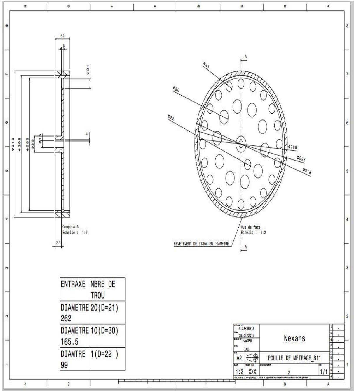
**ANNEXE 5 : Plan de la poulie de renvoi de la machine DELACHEAUX**
