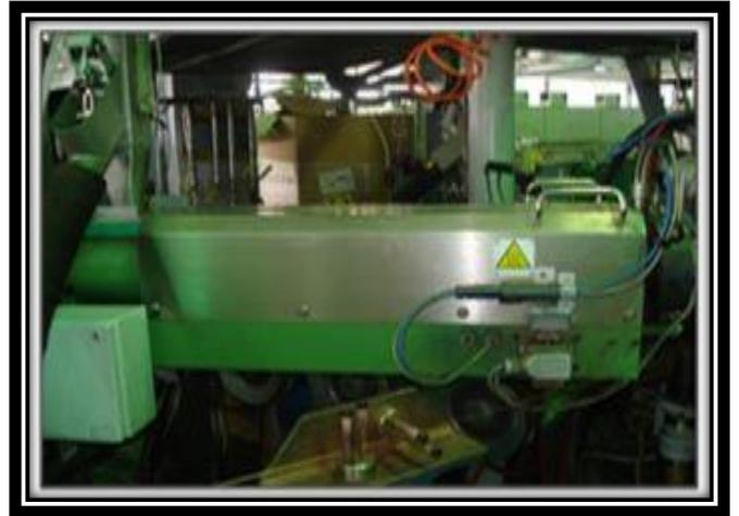
**Figure 8 : Une extrudeuse**
