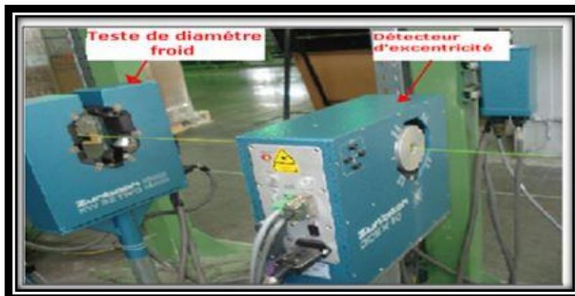
**Figure 14 : L'appareil du test de diamètre**
