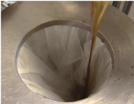
Filtration sur cartouches filtrantes spécifiques
