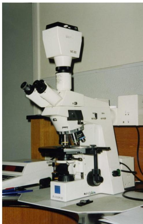
Les particules de polyéthylène sont comptabilisées au moyen de champs microscopiques de 1,65 millimètres carrés (1,35 x 1,22 mm) grâce à un système d'analyse d'image semi-automatique (HISTOLAB <sup>TM</sup>, MICROVISION INSTRUMENTS, Evry, France). La fiabilité du décompte est évaluée par une variance intra-observateur de 3,65% ce qui est une valeur considérée habituellement comme correcte.
