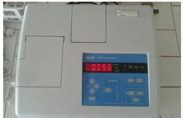
Figure 7 : Turbidimètre
