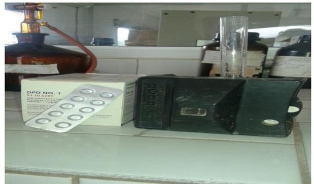
Figure 9 : Comparateur Chlorométrie
