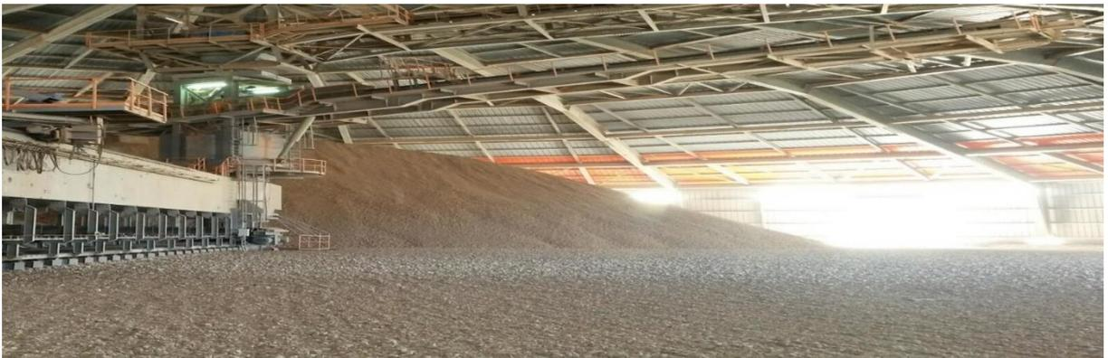
**Figure 2 : Parc de pré-homogénéisation**
