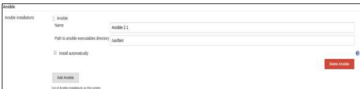
Figure. 35 : Configuration outil Ansible dans Jenkins
