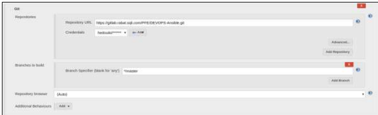
Figure. 36 : Ajout du dépôt git tâche Ansible
