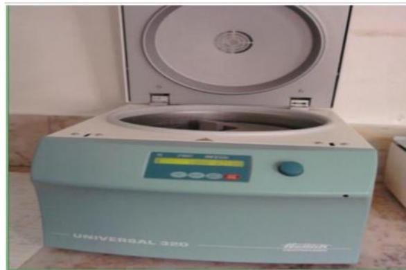
*Figure 6 : Centrifugeuse pour microplaques*
