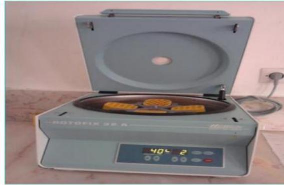
*Figure 5 : Centrifugeuse pour tubes*
