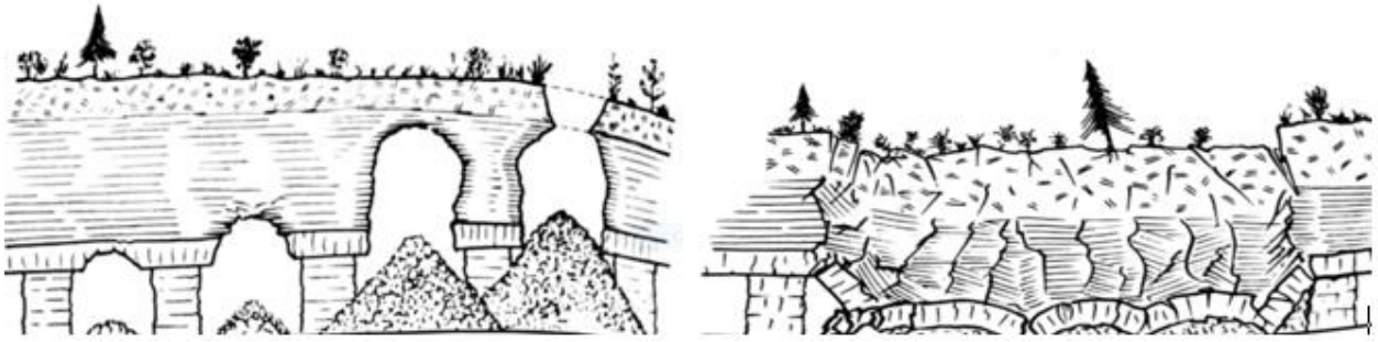
Fig.30. Éboulement d'une carrière à piliers par rupture du toit, et par effondrement des piliers
