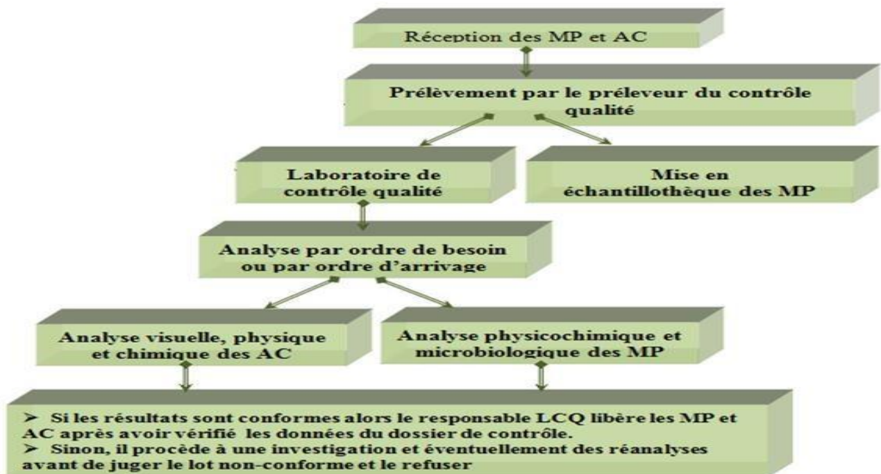
Figure 1 : Circuit d'analyse des matières premières (MP) et articles de conditionnement.
