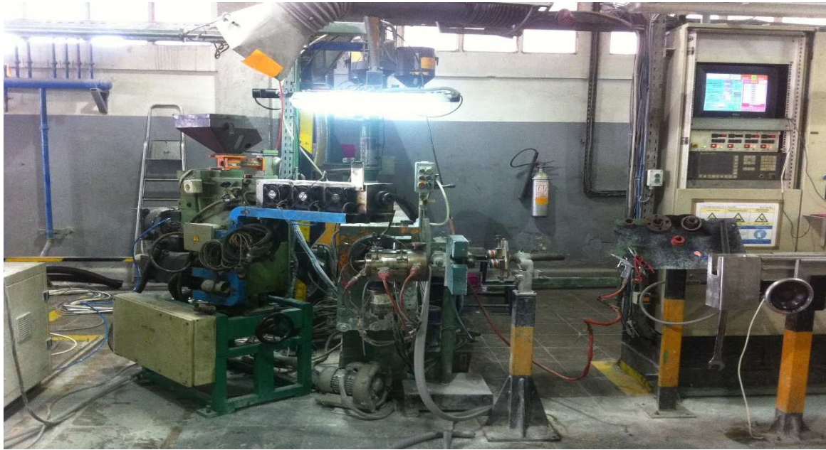
Figure 20 : Extrudeuse auxiliaire sur son nouveau châssis et implanté
