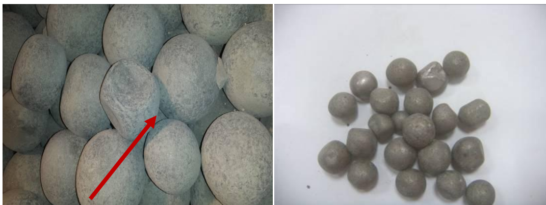
Mauvais état de la charge C1 (usure)
