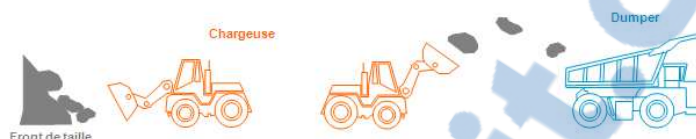
Figure 6: Extraction et transport de la matière première
