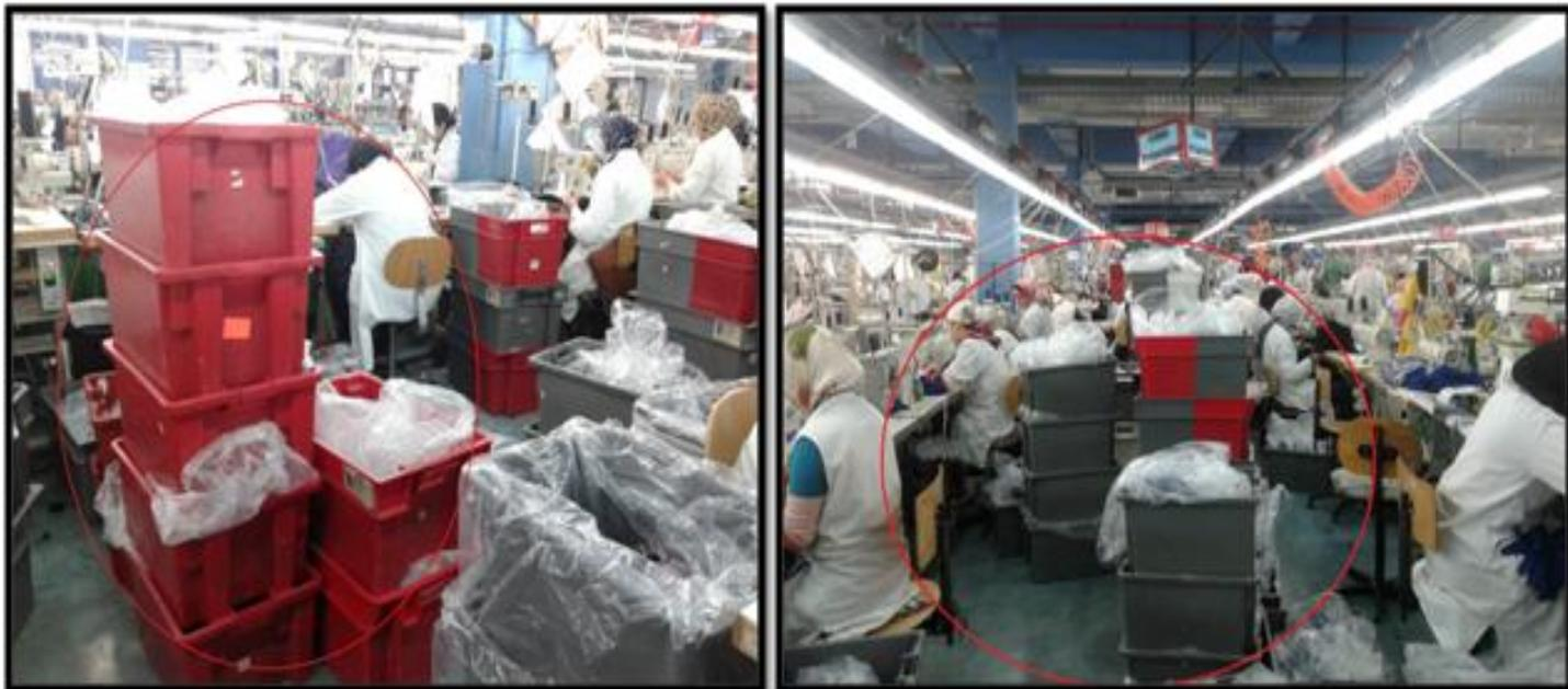
**Figure 18 :** *Les allées de circulation encombrées par des bacs*
