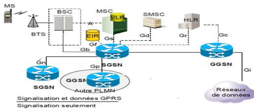
Figure 2 : Evolution de l'architecture de GSM vers GPRS [8]
