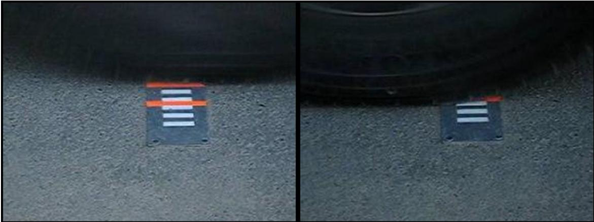
**Figure 3.7 : Arrêts sur image du pneu passant sur le repère visuel**
