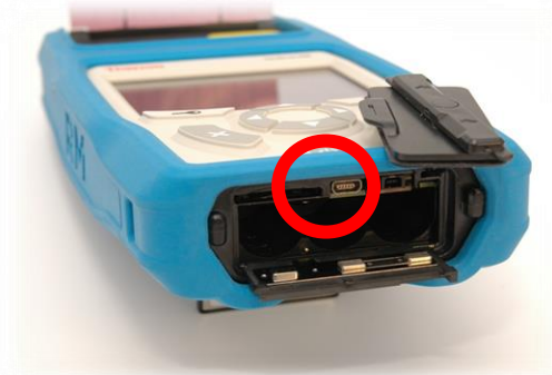
Figure 6: Port d'insertion du câble du TruScan RM
