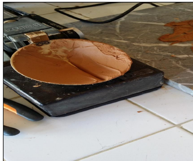
Figure 18 : la forme de la rainure réalisée sur l'échantillon
