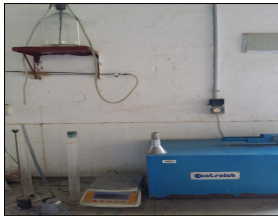
Figure 5 : Appareillage de l'essai d'équivalent de sable
