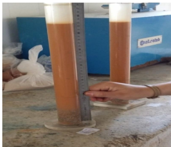
Figure 16 : Mesure des hauteurs
