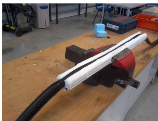
Figure 35 : serrage du joint
