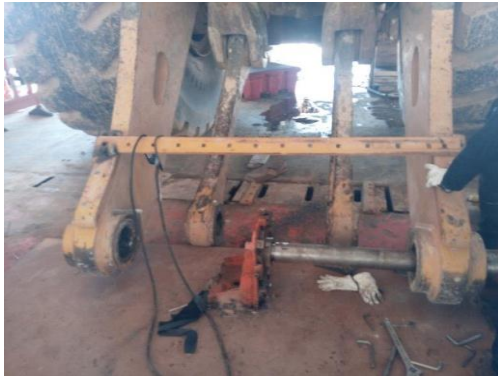
Figure 3.11: usinage de l'alésage coté flèche
